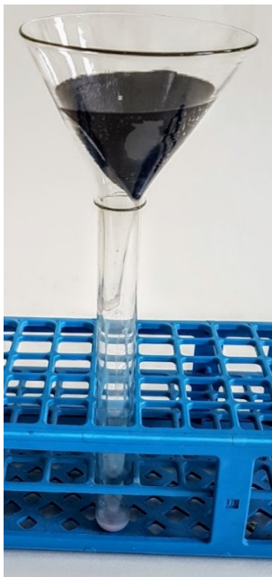
Obrázek 4: Filtrační sestava s uhlíkovým filtrem
