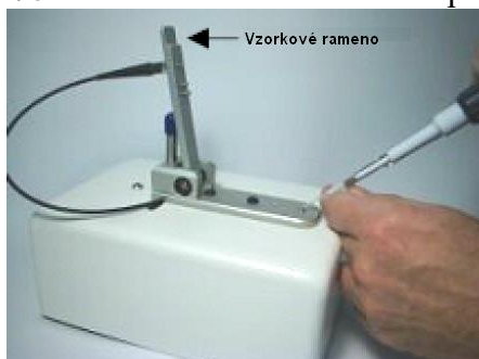
Obr. 5. Nanášení vzorku DNA na spektrofotometr NanoDrop 1000
